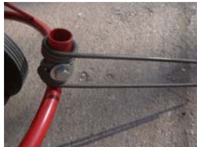
Nasadíte vidlici a pomocí klíčů dotáhněte zajišťovací šroub tak, aby se vidlice mohla na držáku volně pohybovat.
