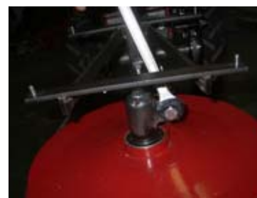
Šroubem O4 nastavte optimální napnutí pohonného řemenu.
