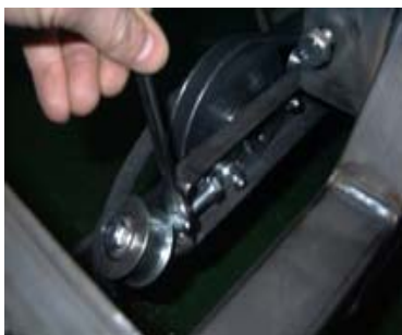
Pootáčením šroubu docílíte optimálního napnutí pohonného řemenu
