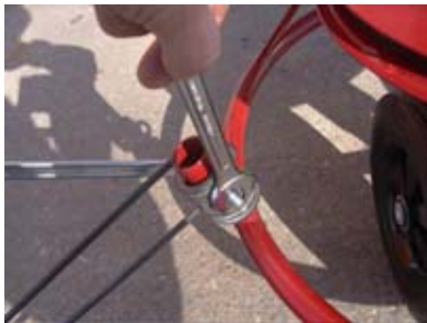
Pomocí klíčů povolte šroub uchycení vidlice
